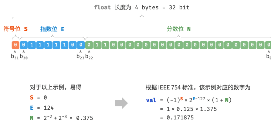
图 3-5 IEEE 754 标准下的 float 的计算示例
