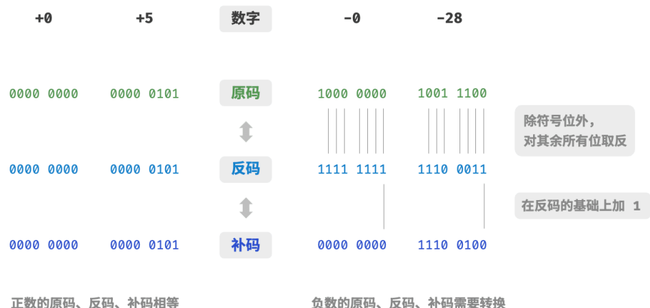
图 3-4 原码、反码与补码之间的相互转换
