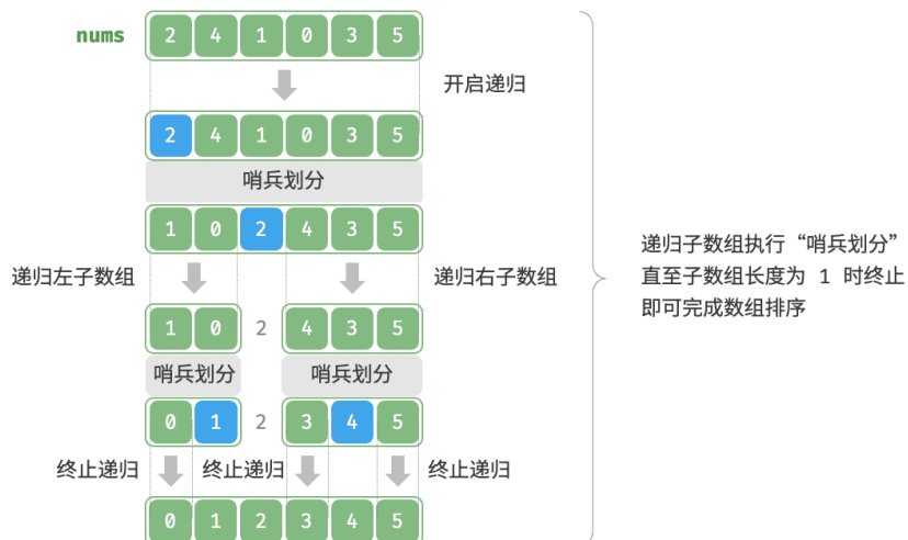
图 11-9 快速排序流程
