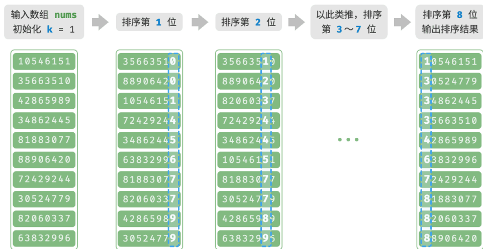
图 11-18 基数排序算法流程
