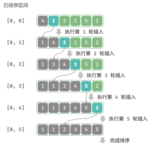
图 11-7 插入排序流程
