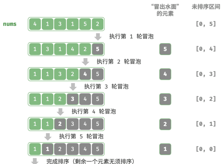
图 11-5 冒泡排序流程
