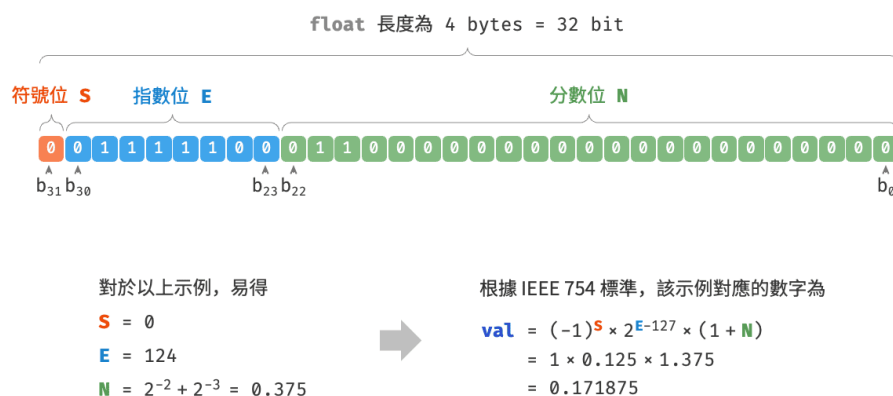
圖 3-5 IEEE 754 標準下的 float 的計算示例
