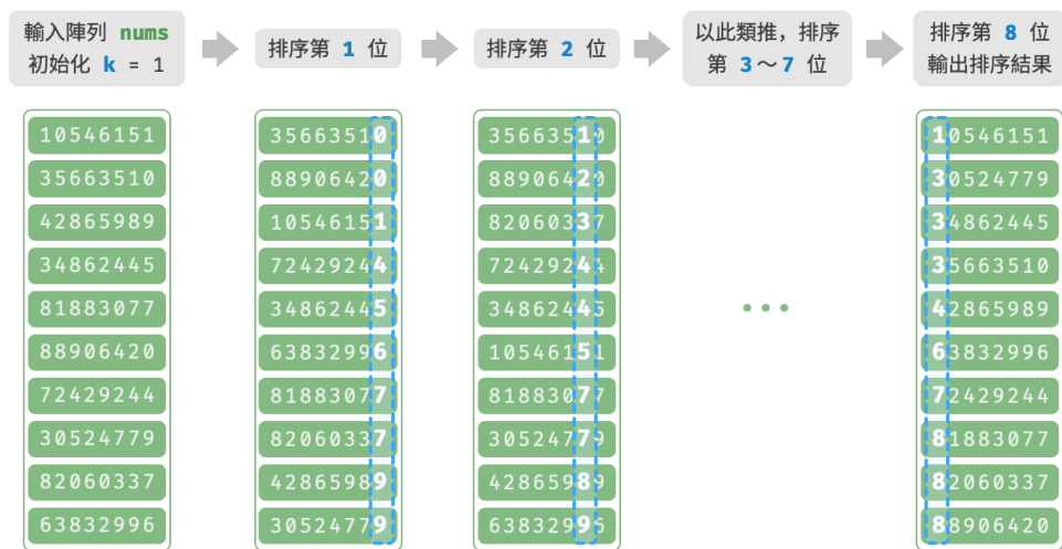
圖 11-18 基數排序演算法流程
