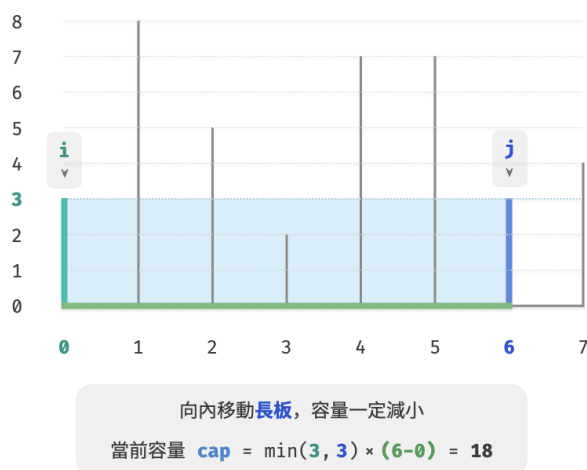
圖 15-9 向內移動長板後的狀態
