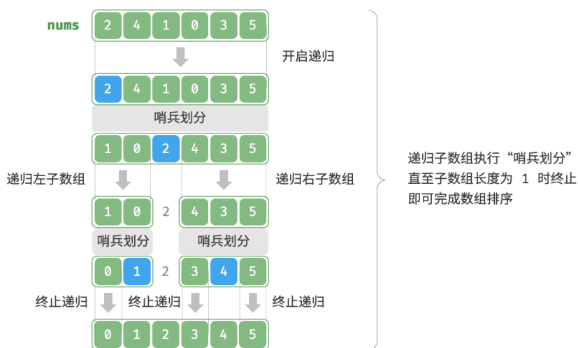
图 11-9 快速排序流程
