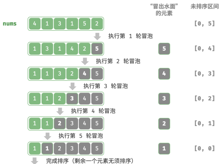
图 11-5 冒泡排序流程
