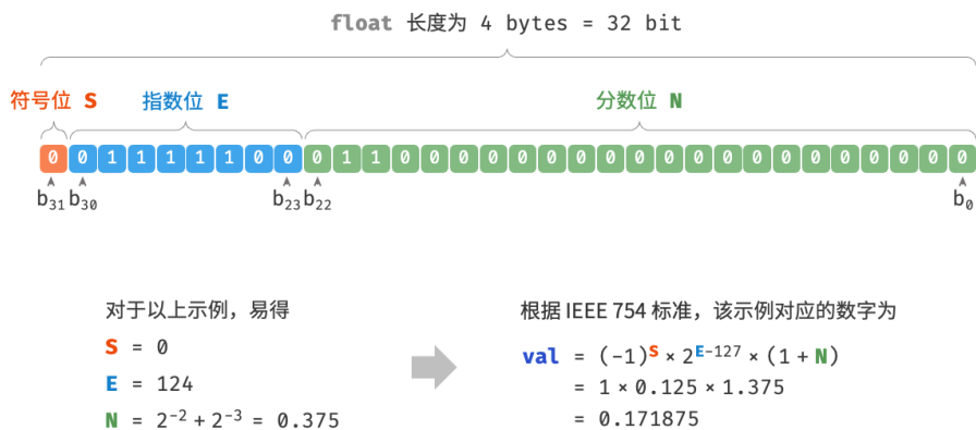
图 3-5 IEEE 754 标准下的 float 的计算示例
