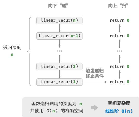
图 2-17 递归函数产生的线性阶空间复杂度
