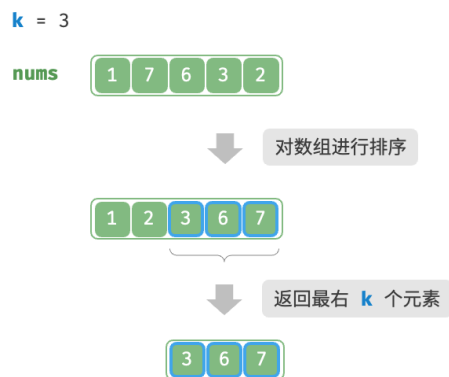
图 8-7 排序寻找最大的 k 个元素
