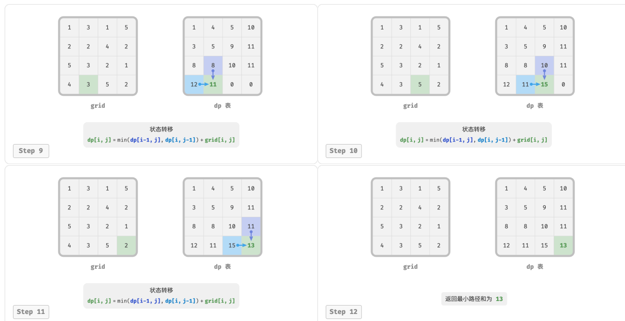
图 14-16 最小路径和的动态规划过程
