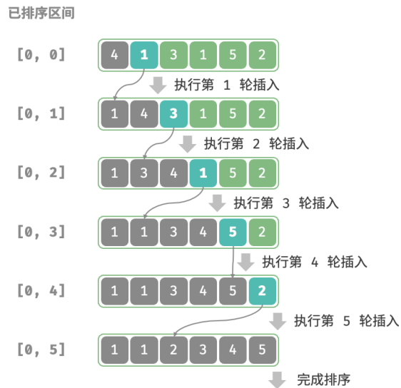
图 11-7 插入排序流程
