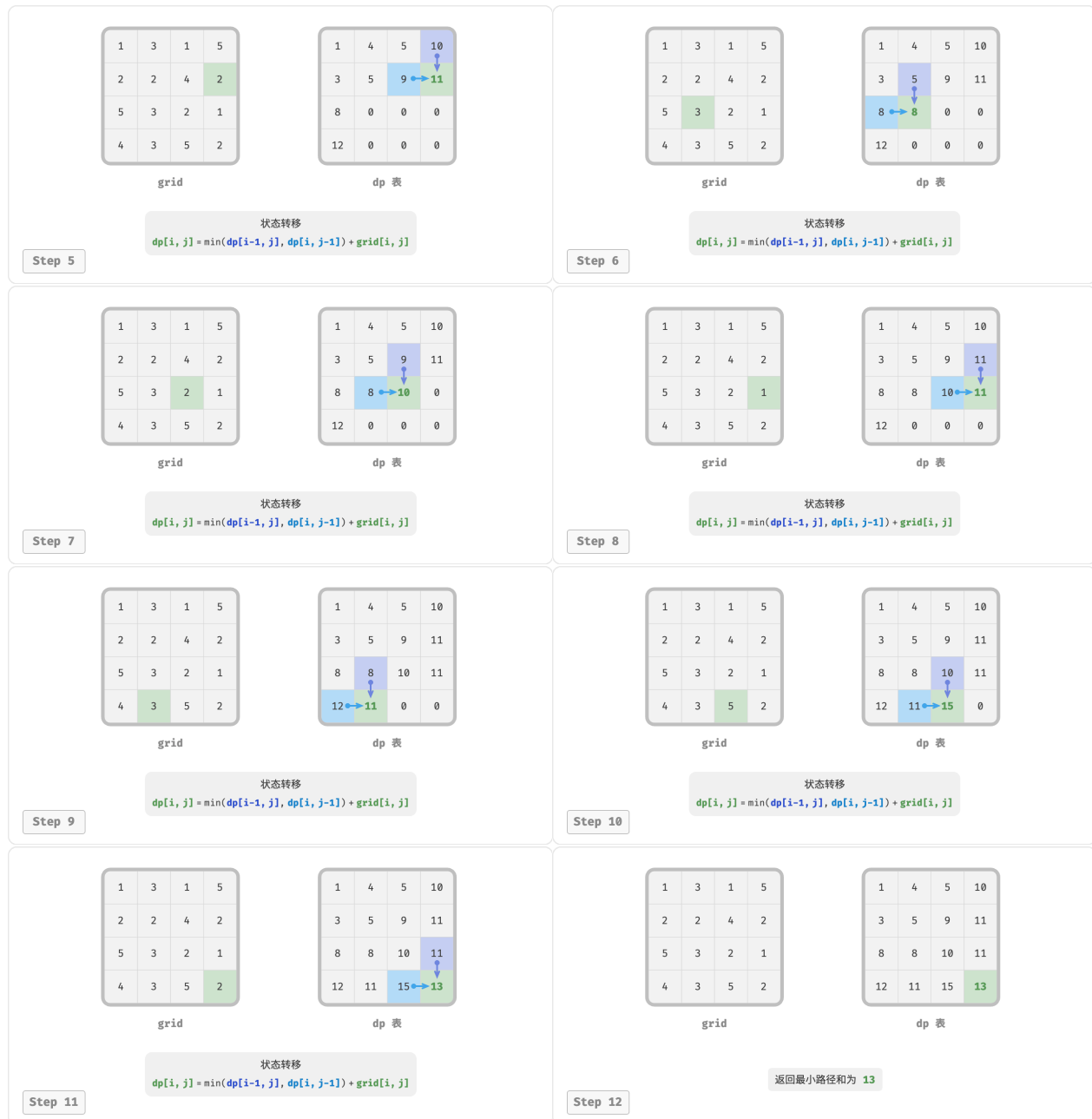
图 14-16 最小路径和的动态规划过程
