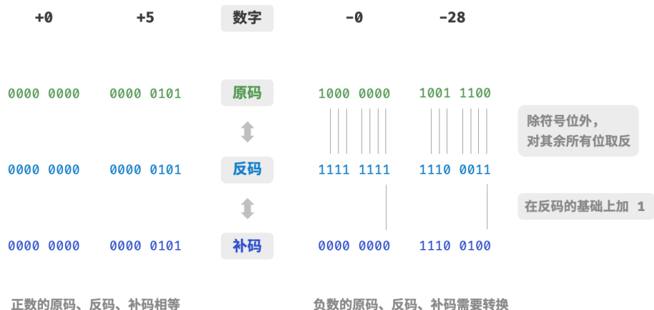
图 3-4 原码、反码与补码之间的相互转换
