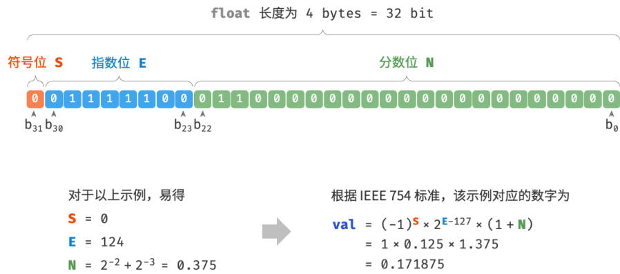
图 3-5 IEEE 754 标准下的 float 的计算示例
