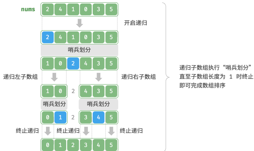
图 11-9 快速排序流程
