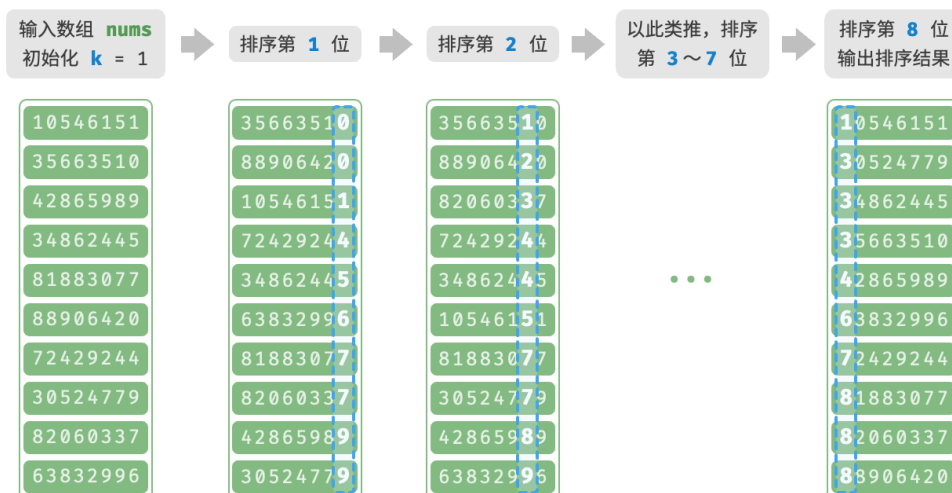
图 11-18 基数排序算法流程
