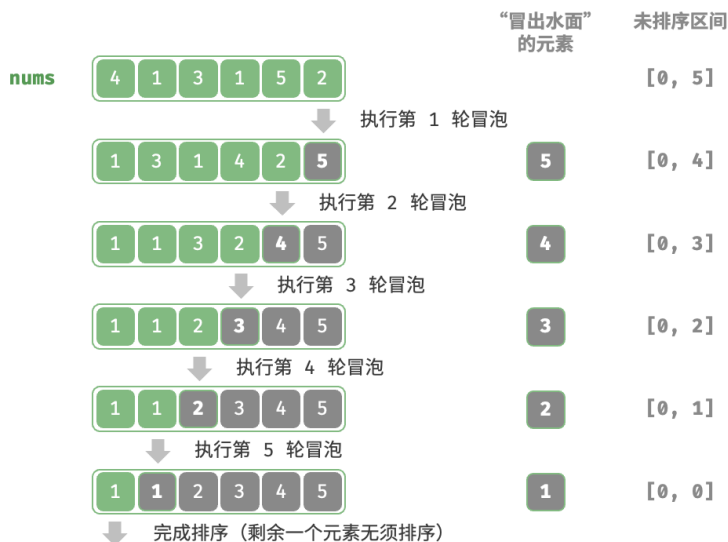
图 11-5 冒泡排序流程
