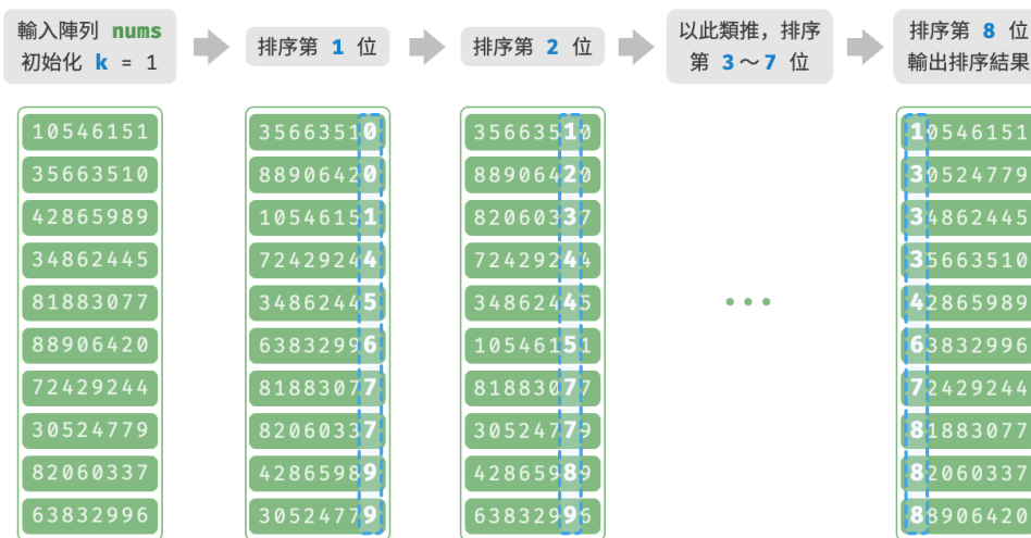
圖 11-18 基數排序演算法流程
