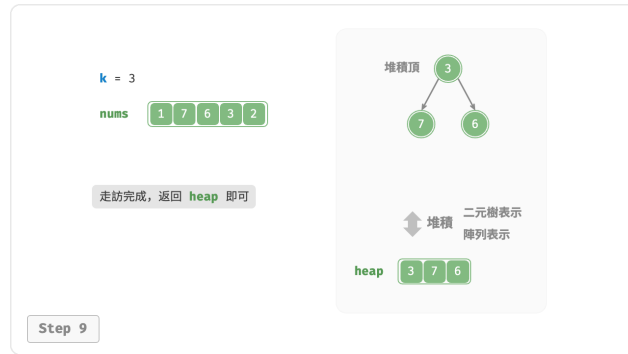
圖 8-8 基於堆積尋找最大的 k 個元素
