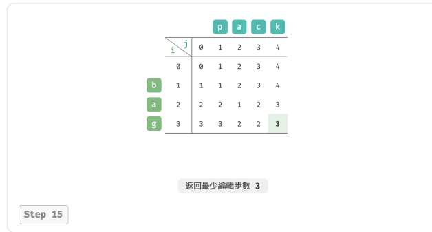
圖 14-30 編輯距離的動態規劃過程
