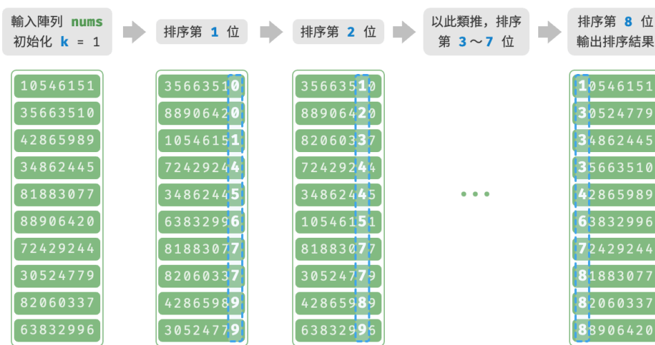
圖 11-18 基數排序演算法流程
