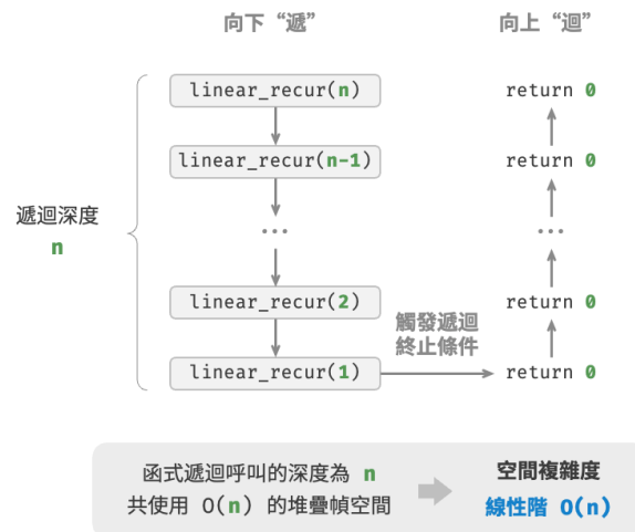
圖 2-17 遞迴函式產生的線性階空間複雜度
