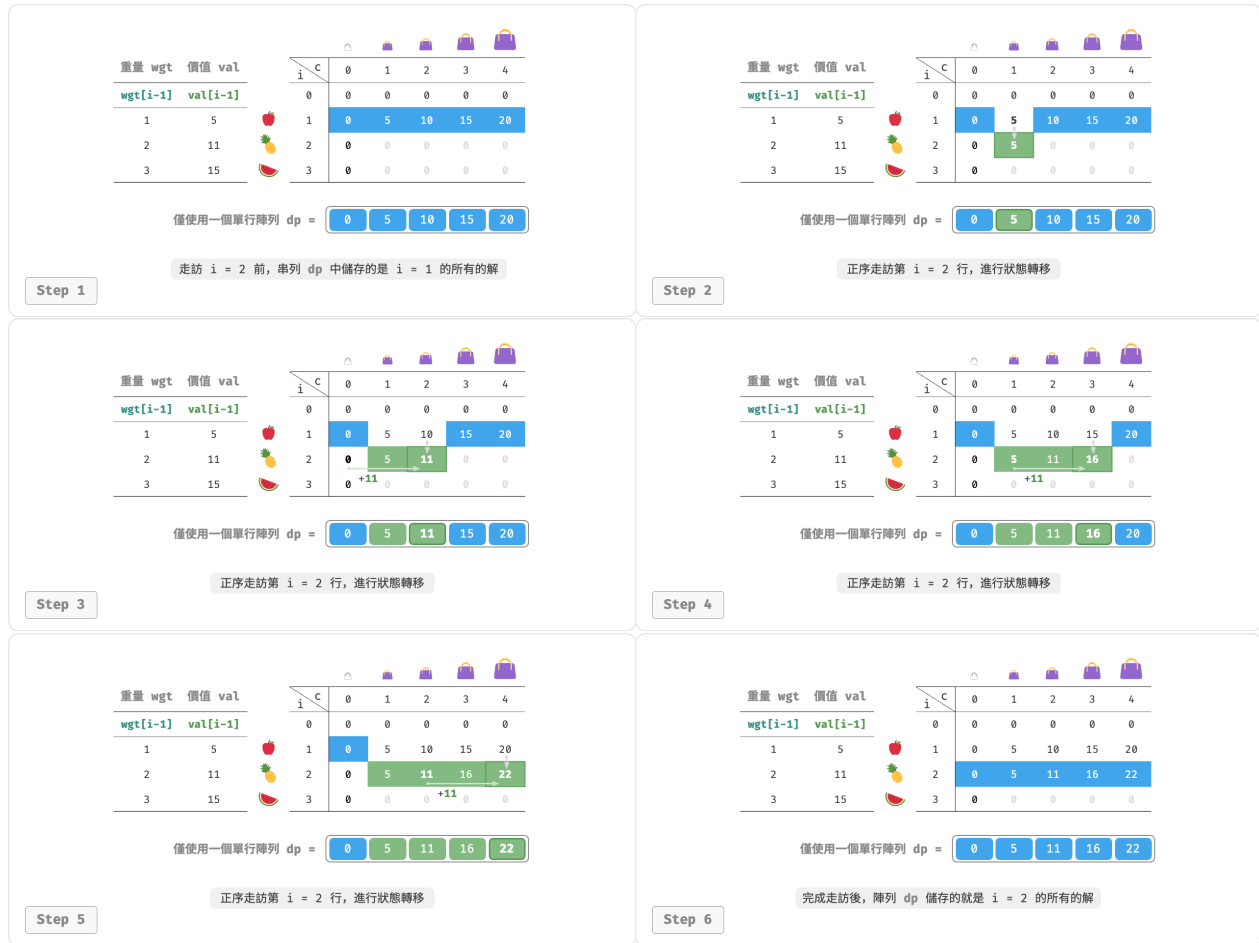
圖 14-23 完全背包問題在空間最佳化後的動態規劃過程
