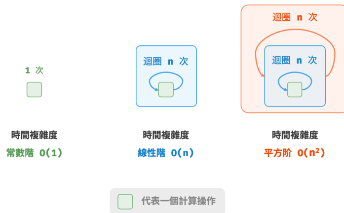
圖 2-10 對比了常數階、線性階和平方階三種時間複雜度。
