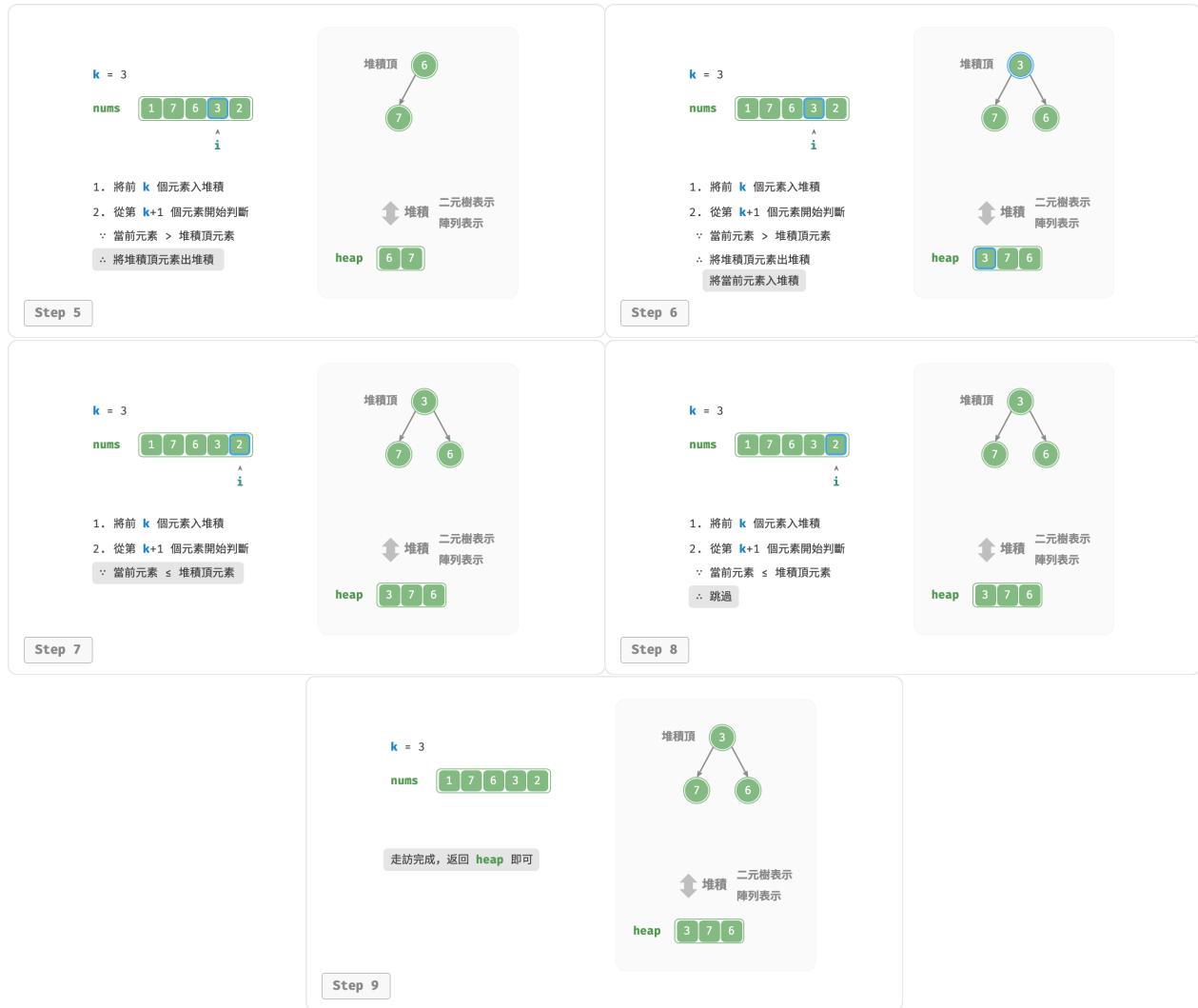
圖 8-8 基於堆積尋找最大的 k 個元素
