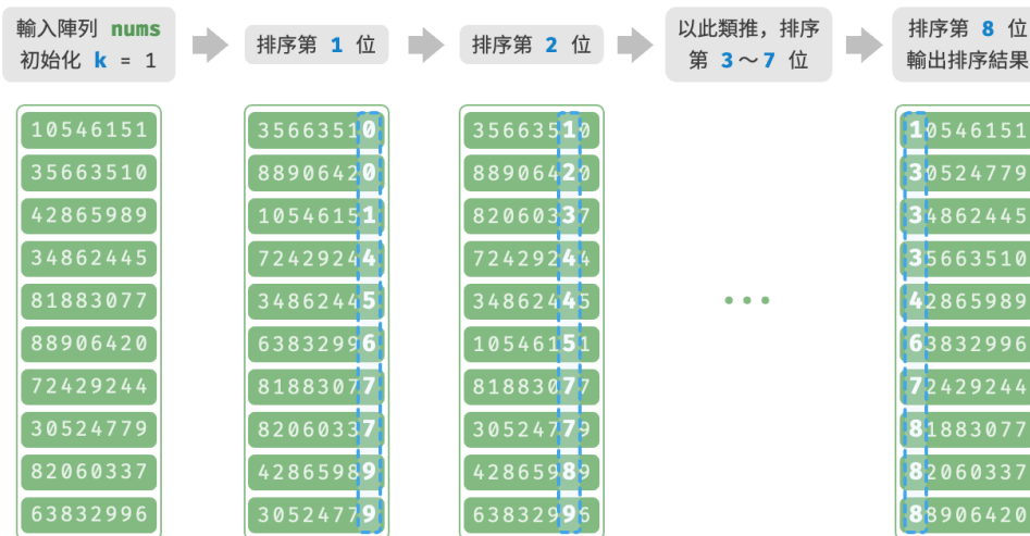
圖 11-18 基數排序演算法流程
