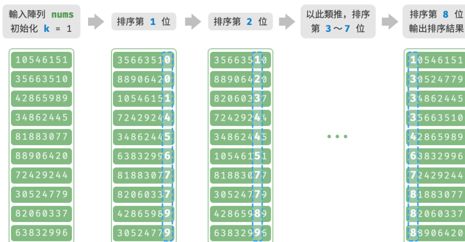
圖 11-18 基數排序演算法流程
