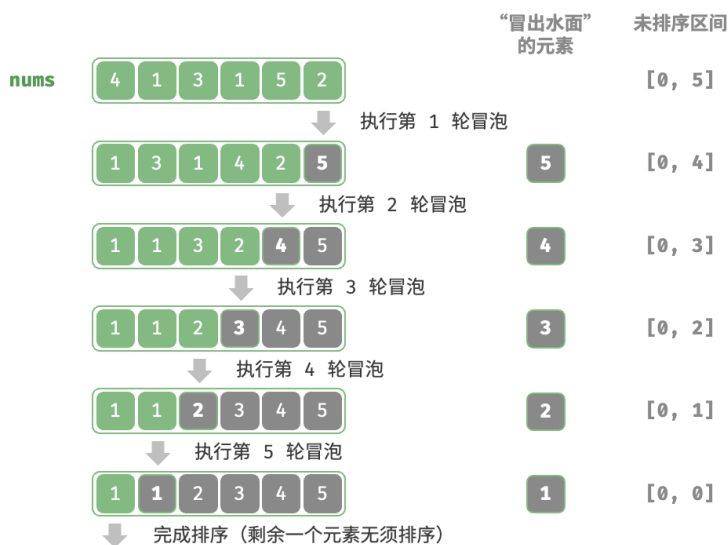
图 11-5 冒泡排序流程
