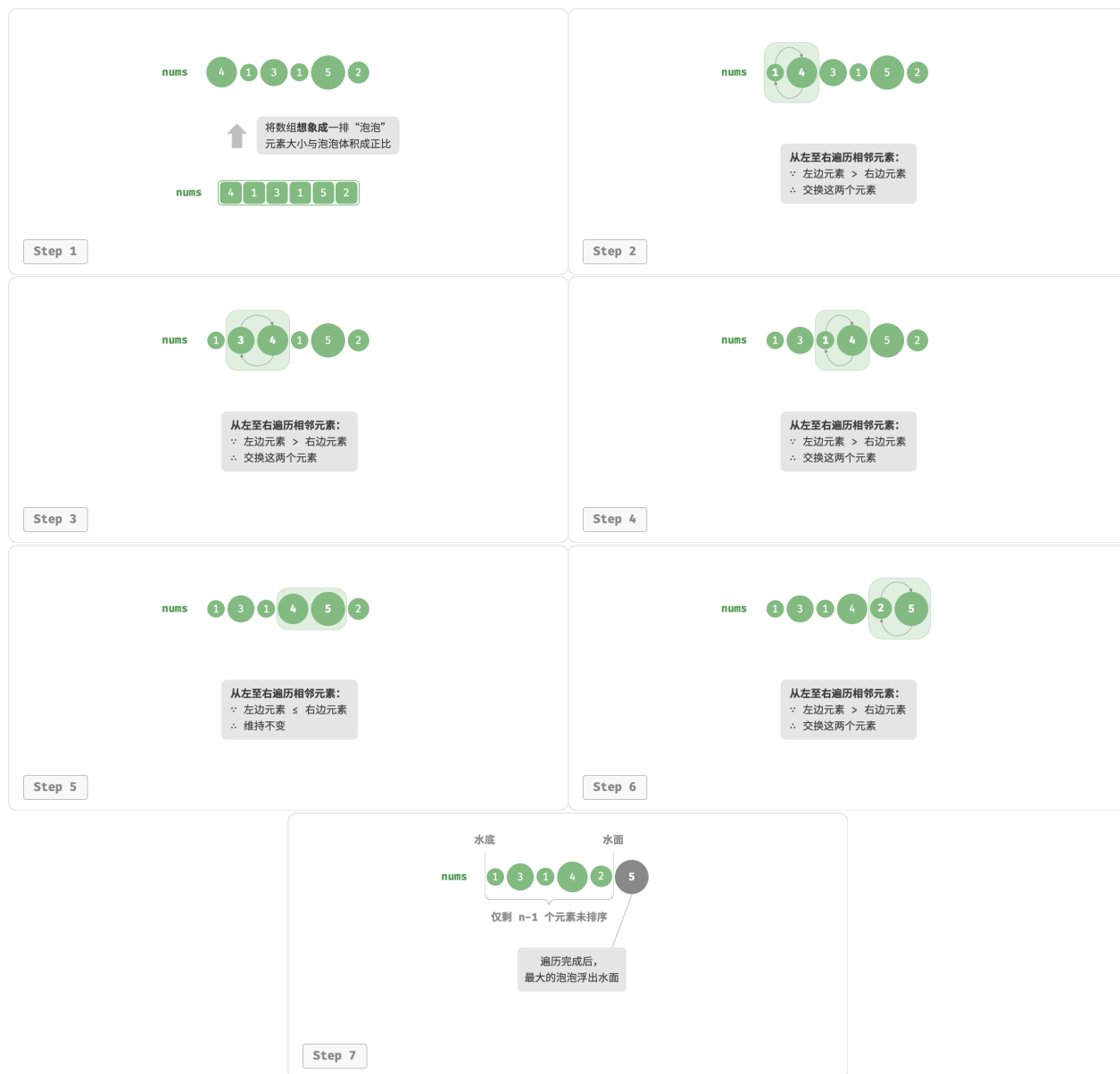
图 11-4 利用元素交换操作模拟冒泡
