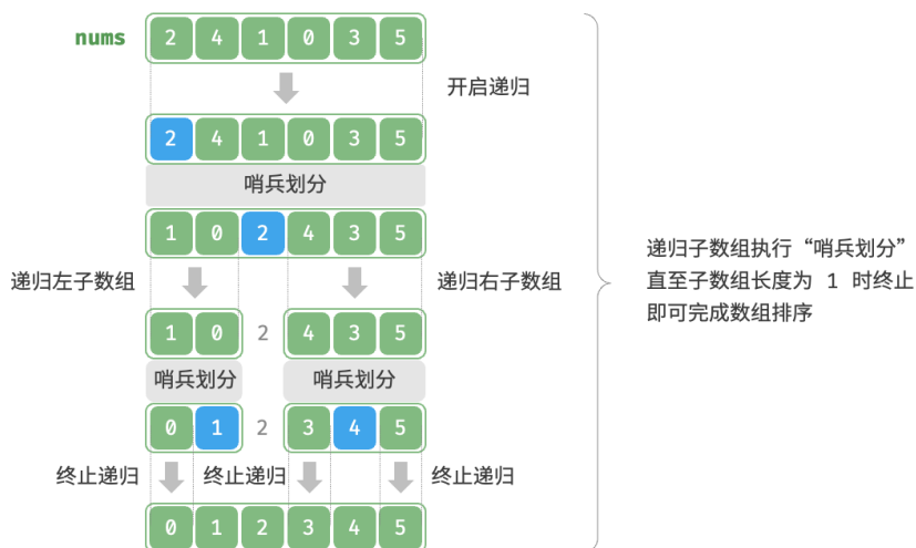
图 11-9 快速排序流程
