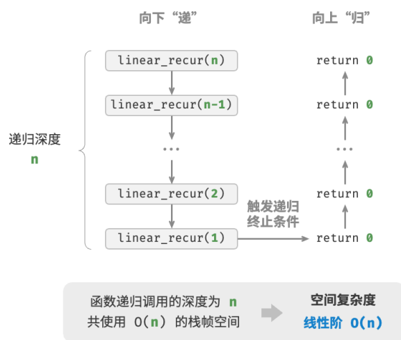
图 2-17 递归函数产生的线性阶空间复杂度
