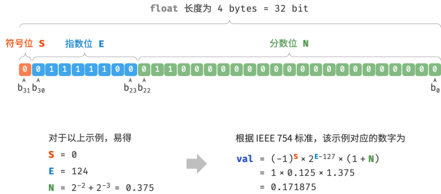
图 3-5 IEEE 754 标准下的 float 的计算示例
