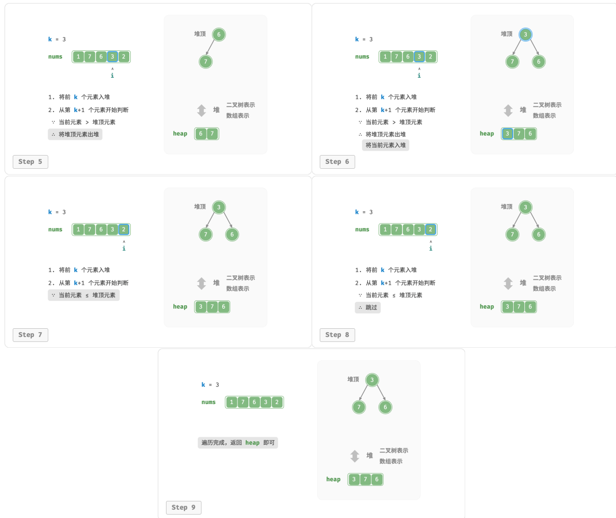
图 8-8 基于堆寻找最大的 k 个元素
