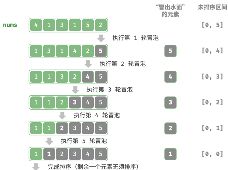
图 11-5 冒泡排序流程
