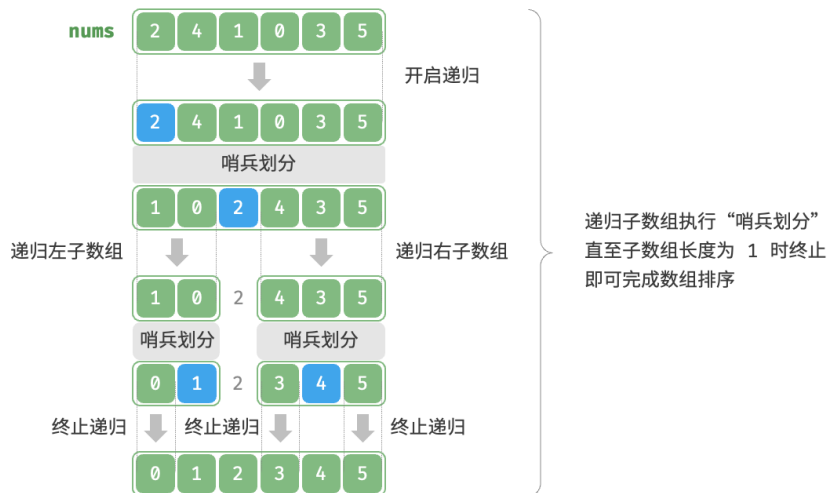
图 11-9 快速排序流程
