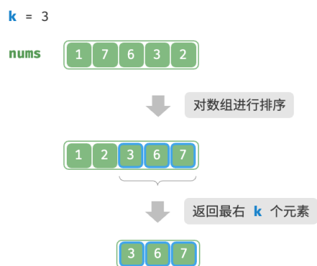
图 8-7 排序寻找最大的 k 个元素
