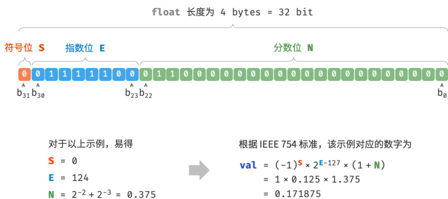
图 3-5 IEEE 754 标准下的 float 的计算示例
