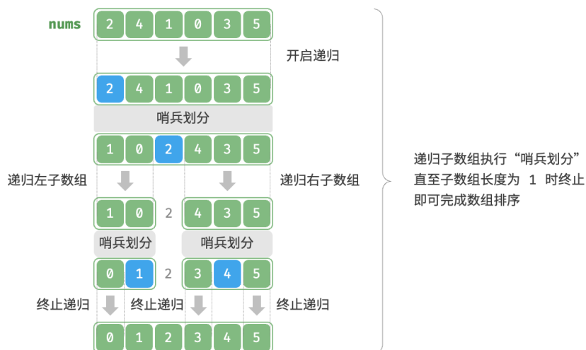
图 11-9 快速排序流程
