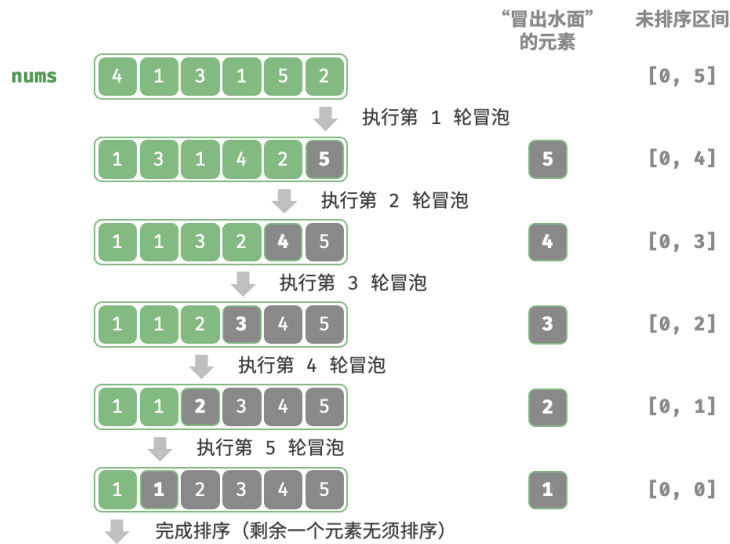
图 11-5 冒泡排序流程
