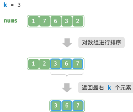
图 8-7 排序寻找最大的 k 个元素
