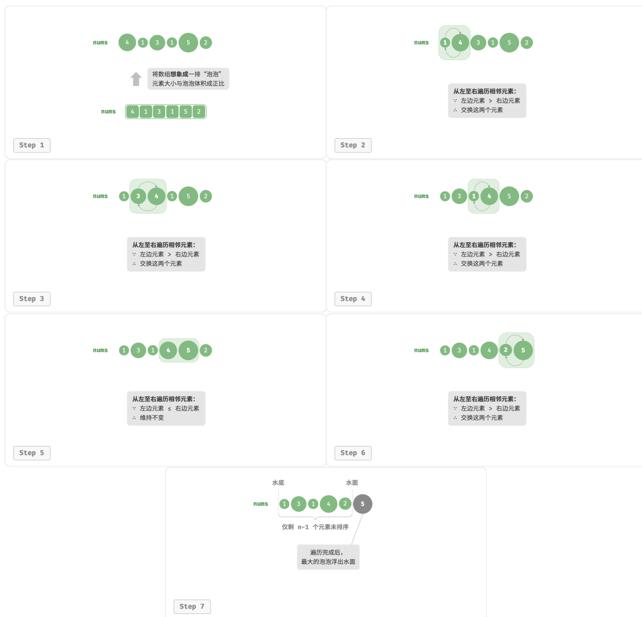
图 11-4 利用元素交换操作模拟冒泡
