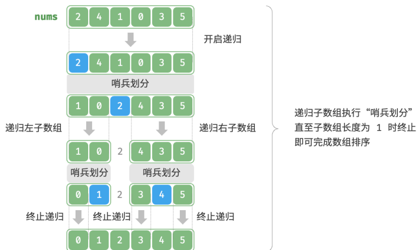
图 11-9 快速排序流程
