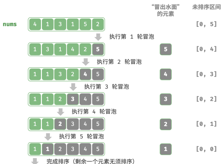
图 11-5 冒泡排序流程
